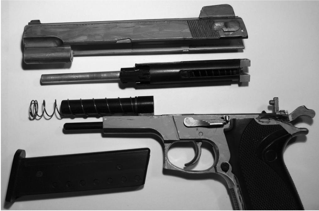
Abbildung 7: Zerlegte Federdruckpistole
